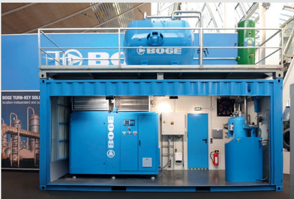
Schlüsselfertige Containeranlage zur Erzeugung von N 2 präsentiert auf der Hannover Messe 2013
